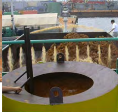
그림 7. 황토살포기 이용하여 어장에 유입된 적조에 대하여 어장방향으로 황토살포
